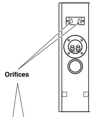
S'assurer que les vis sont solidement engagées dans la partie étroite des orifices.
