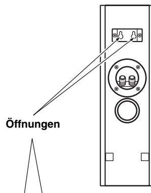
Achten Sie darauf, dass die Schrauben sicher im engen Teil der Löcher festgehalten werden.
