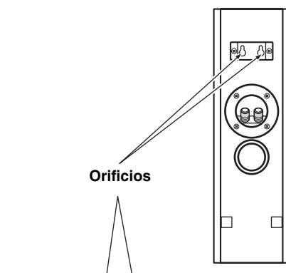
Asegúrese de que los tornillos quedan bien fijos en la parte estrecha de los orificios.
