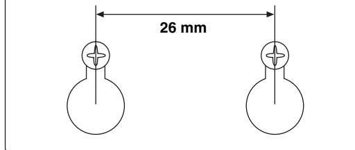
Fije los tornillos en una pared o un soporte de pared firme, tal como se muestra en la figura siguiente, y enganche los agujeros los tornillos que sobresalen.
