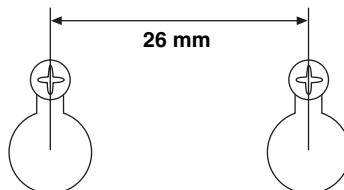
Drehen Sie die Schrauben in eine feste Wand oder Wandstütze, wie in der Abbildung unten gezeigt, und hängen Sie die Löcher an die vorstehenden Schrauben.
