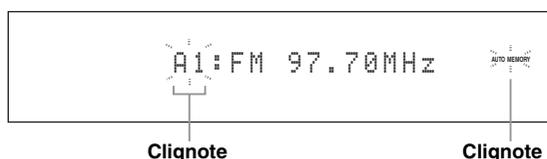
Lorsque la mise en mémoire automatique est terminée, la dernière fréquence retenue est indiquée sur l'afficheur de la face avant.
