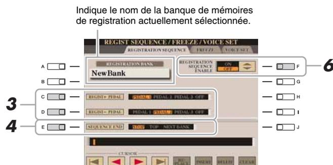
**4** Utilisez la touche [E] (SEQUENCE END) (Fin de séquence) pour déterminer le comportement du paramètre Registration Sequence à la fin de la séquence.
