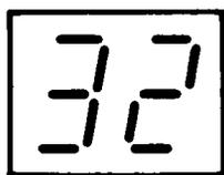
Le mode Exécution est automatiquement sélectionné à la mise sous tension du TX816. Cependant, si vous avez déjà utilisé le TX816 et s'il fonctionne dans un autre mode, entrez le mode Exécution en maintenant SW3 enfoncé jusqu'à ce qu'un nombre compris entre 1 et 32 apparaisse sur l'affichage à LED. Les modes principaux apparaissent dans le même ordre que les chapitres correspondants dans ce manuel.
