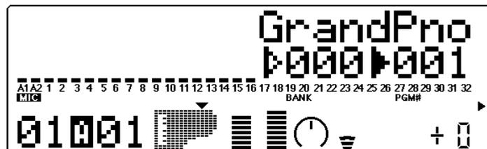
Zeigt ganze Pegelanzeigen für die A/D-Parts A1 und A2 sowie für die Parts 1–16. Die aktuell gewählten Parameter (hier Voice-Nummer und -Name) werden rechts angezeigt.
