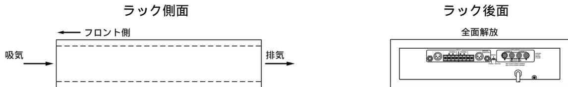
2. パワーアンプを使用する際、放熱空気流を妨げないように設置してください。
