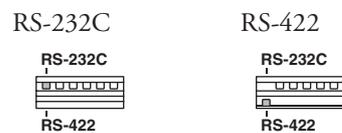
**! VORSICHT** Wenn Sie nicht vorhaben, den DME Satellite zu initialisieren, stellen Sie alle „Bits“ des Dip-Schalters (außer dem für die RS-422-Einstellung) in die obere Position.
