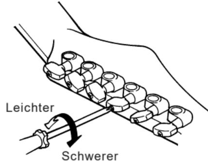
Beim Drehen im Uhrzeigersinn nimmt der Widerstand zu und beim Drehen entgegen den Uhrzeigersinn ab. Die Wirbel sollten so gespannt sein, daß sie sich nicht leicht verstellen, aber dennoch ohne großen Kraftaufwand drehbar sind. Verstellen der Einstellschrauben ist im Normalfall nicht erforderlich; zu hohe Spannung kann frühzeitigen Verschleiß der Stimmmechanik zur Folge haben.
