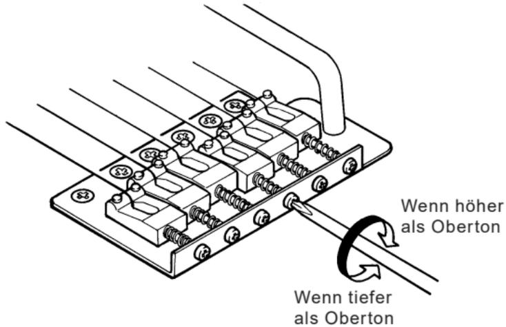
Zur Prüfung der Intonation den Ober- bzw. Flageoletton (12. Bund) mit dem gegriffenen Ton (12. Bund) vergleichen.
