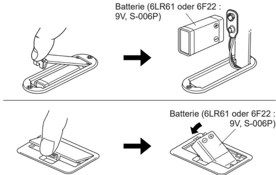
\* Achten Sie beim Auswechseln der Batterie auf korrekte Ausrichtung der Batteriepole (+/-), wie in der obigen Abbildung dargestellt.
