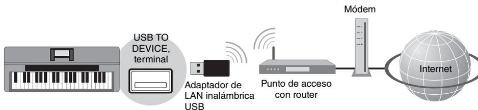
\*Aquí, “módem” se refiere a un módem ADSL, una unidad de red óptica (ONU) o un módem por cable.
