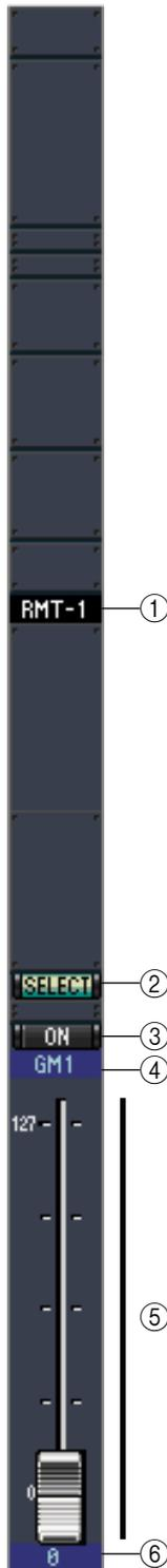
Wenn Sie im „Master“-Fenster den REMOTE LAYER-Button wählen, werden die „Remote“-Kanäle angezeigt.
