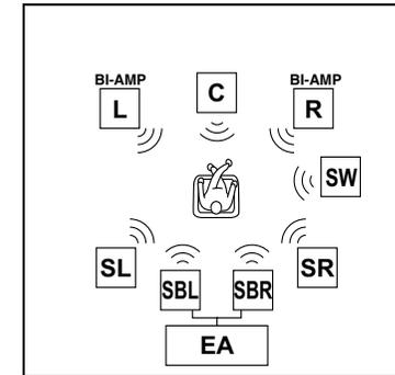
Le raccordement des enceintes surround arrière à un amplificateur externe permet une utilisation simultanée des enceintes avant qui prennent en charge la connexion bi-amplificatrice et les enceintes surround arrière.
