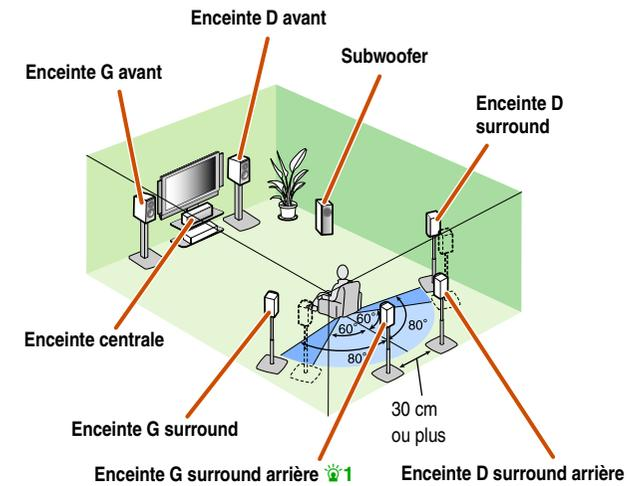
Le son d'une source audio à 7.1 voies peut être restitué sans dégradation grâce à cette configuration des enceintes.
