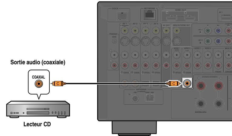
Nous vous recommandons de raccorder les appareils audio avec une sortie numérique coaxiale à la prise numérique coaxiale AUDIO2 sur cette unité. Ce raccordement vous permet de basculer sur l'AUDIO2 en appuyant simplement sur la touche « CD » SCENE (p. 50).
