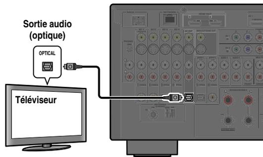
Lorsque le téléviseur est connecté avec HDMI OUT 2, la prise d'entrée par défaut est AUDIO3. Si la prise numérique optique AUDIO3 est raccordée à la prise de sortie audio du téléviseur, vous pouvez alors profiter d'un son TV directement via cet appareil.
