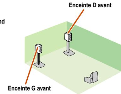
En plus de la pièce principale, il est possible de commander des enceintes situées dans une autre pièce. Lorsque l'amplificateur intégré attribué aux enceintes dans une autre pièce est activé, la sortie sonore passe automatiquement des enceintes surround arrière aux enceintes dans l'autre pièce. 👁️ 2
