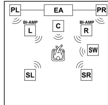
Un champ sonore plus riche peut être créé en utilisant en même temps les enceintes avant qui prennent en charge la connexion bi-amplificatrice et les enceintes de présence avant.
