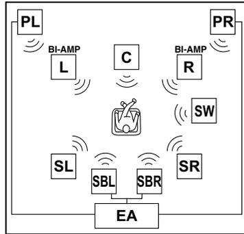
Lorsqu'un amplificateur externe est utilisé, les enceintes de présence avant et les enceintes surround arrière peuvent être utilisées simultanément avec les enceintes avant qui prennent en charge la connexion bi-amplificatrice. 🌟1
