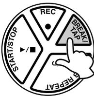
Drücken Sie während der Song-Wiedergabe die Taste [BREAK/TAP]. Die drei Beat-Lämpchen leuchten im Display auf und kennzeichnen, daß sich das DD-55 im Standby-Modus für die Funktion BREAK befindet. Zum Abbrechen des Modus BREAK drücken Sie einfach die Taste [BREAK/TAP] erneut. (Die Beat-Lämpchen blinken im Tempo.)
