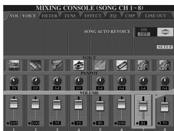
Sur l'écran intitulé Mixing Console (Console de mixage), le paramètre sélectionné pour l'édition est en surbrillance. Utilisez le cadran [DATA ENTRY] pour le régler.
