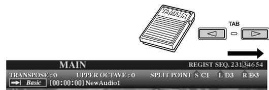
Lorsque le réglage SEQUENCE END (Fin de séquence) est paramétré sur « NEXT BANK » (Banque suivante), la séquence se déplace automatiquement au début de la banque de mémoires de registration suivante du même dossier.
