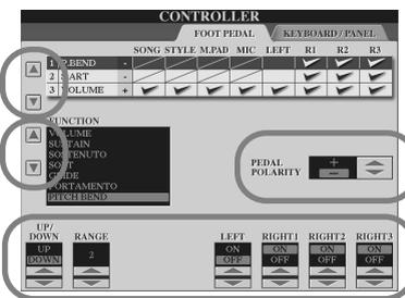
L'activation ou la désactivation de la pédale (on/off) peut varier selon le type de pédale que vous avez connecté à l'instrument. Par exemple, le fait d'appuyer sur une pédale active la fonction sélectionnée, alors qu'avec une autre marque de pédale, cela pourra désactiver la fonction. Si nécessaire, utilisez ce réglage pour inverser le fonctionnement.
