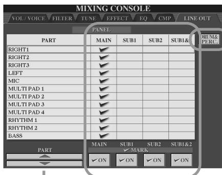
Réglez la configuration de sortie de la partie sélectionnée en cochant ou décochant la colonne appropriée (prise).
