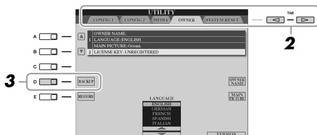
**3** Pulse el botón [D] (BACKUP) para guardar los datos en el dispositivo de almacenamiento USB.
