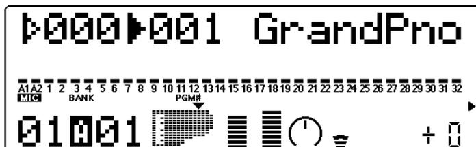
Zeigt halbe “Pegelmessung”-Anzeige für die A1 und A2 A/D Parts sowie alle 32 Parts. Derzeit ausgewählte Parameter (hier Voice-Number und -Name) werden oben angezeigt.
