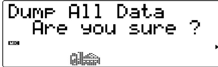
Damit werden alle MU80-Daten (einschließlich Part, Performance, System und alle Parameter-Werte) zum angeschlossenen Gerät übertragen.
