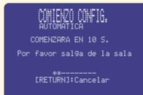
La pantalla de configuración cambia automáticamente durante el procedimiento AUTO SETUP. Si se produce un error, un mensaje de error correspondiente aparece en la pantalla. En este caso, consulte "Mensaje de error para AUTO SETUP" en la página 33 del manual del propietario y luego siga las instrucciones. Para iniciar de nuevo el procedimiento AUTO SETUP, pulse RETURN y luego realice el procedimiento desde el paso 5.
