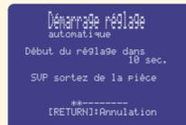
L'écran de réglage change automatiquement pendant la procédure AUTO SETUP. En cas d'erreur, le message d'erreur correspondant apparaît sur l'écran. Si le cas se présente, reportez-vous à "Messages d'erreur pour AUTO SETUP" à la page 33 dans le Mode d'emploi et suivez les instructions pour résoudre le problème. Pour redémarrer la procédure AUTO SETUP, appuyez sur RETURN puis exécutez la procédure depuis l'étape 5.
